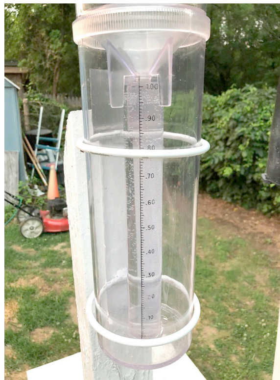
La medición de la lluvia, que se realiza mediante un pluviómetro o un pluviógrafo.
