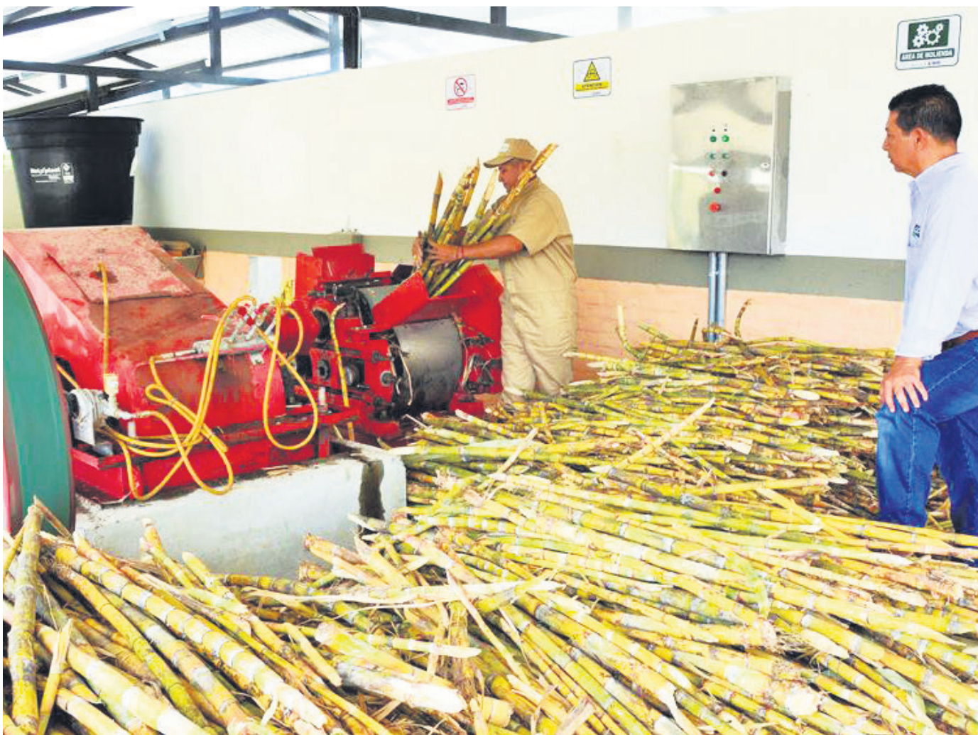
La apuesta es tener trapiches modernos para extraer el 70% de guarapo de la caña.
